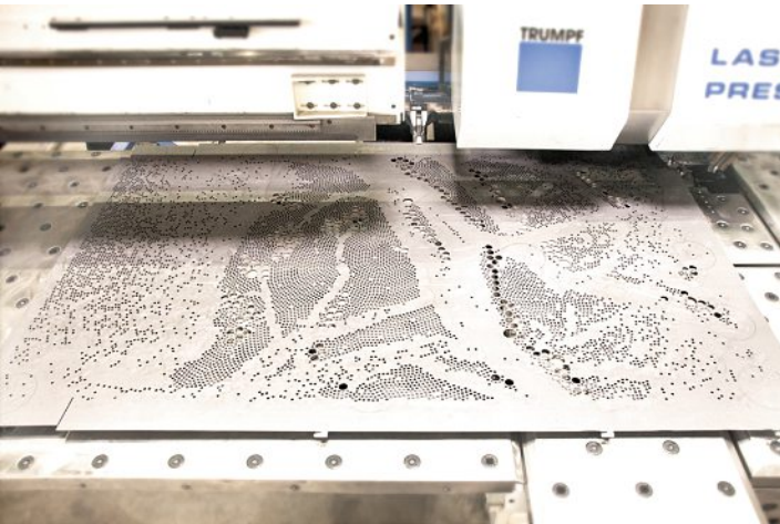
Die Lochungen sind mit einer CNC-gesteuerten Maschine gestanzt worden. Les perforations ont été découpées à l'aide d'une machine CNC.
