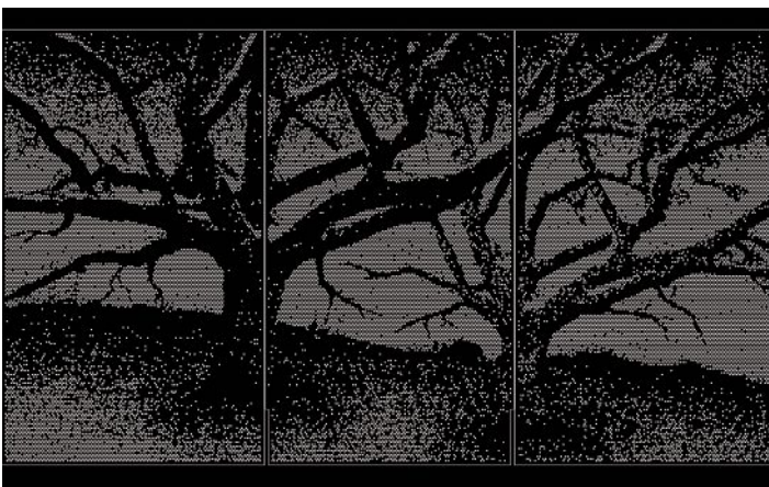
Berechnete Rasterung auf Basis des Eingabebilds und einer Auflösung des Perforationsmusters pro Paneel von 220 \times 134 Löchern mit gleicher Lochgröße \varnothing 8 \text{ mm} . Resultat: Motiv ist gut erkennbar. Die Lochung ist jedoch weniger lebendig/interessant.
